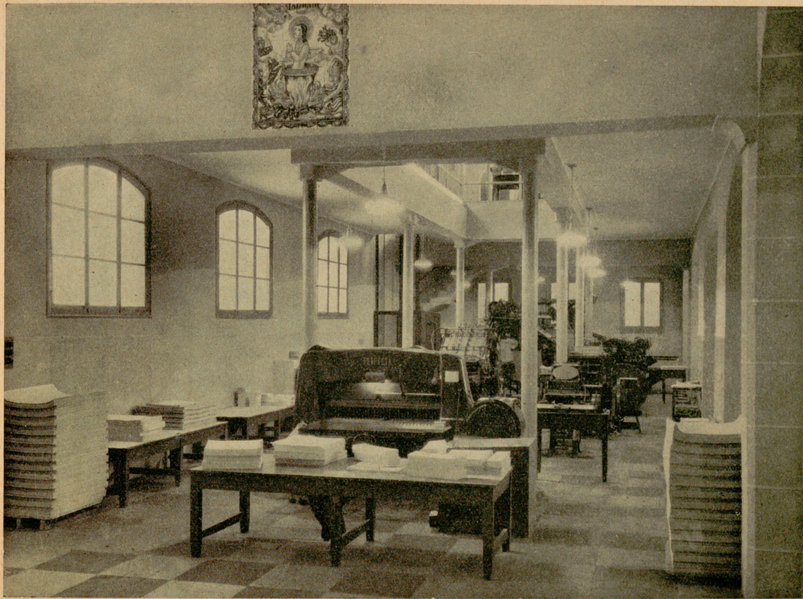
Planta baja : Guillotina capaz para el corte de 1'30 m.
