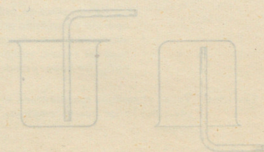
Dispositivo a) gas menos denso que el aire. Dispositivo b) gas más denso que el aire.
