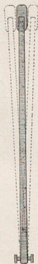
Fig. 3 Un desgaste del grueso de un papel de fumar en el eje, produce una desviación de 4 á 5 m/m en la escritura.
