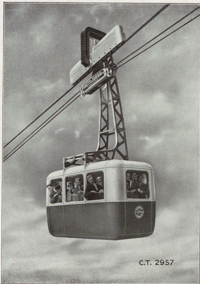
Vagoneta para el transporte de personas con carro corredizo elastico hidropneumatico.
