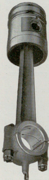
El perno del émbolo templado superficialmente, rectificando y amolado está fijado en la cabeza de biela y gira en bujes de bronce en el émbolo
