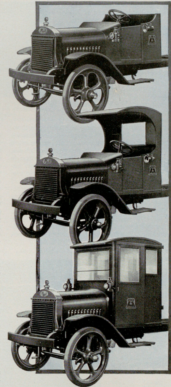
La dotación corriente comprende el asiento descubierto que se ve en el grabado superior. Mediante un pequeño recargo, puede suministrarse la garita cubierta que se ve en el centro. Para mayor protección, se suministra la garita completamente cerrada
