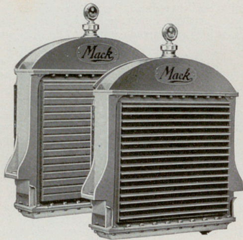
El enfriamiento eficaz se obtiene mediante un radiador con núcleo de aletas continuas y postigos de acero regidos a mano. El sólido tanque superior de latón, el tanque inferior de aluminio y las chapas laterales del mismo metal montados con tacos de goma, suprimen todas las posibilidades de desarreglo
