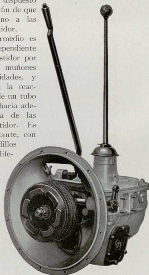
Vense aquí el embrague, el mecanismo de desembrague, la caja acampanada y la montadura S.A.E. para bomba de inflar neumáticos
