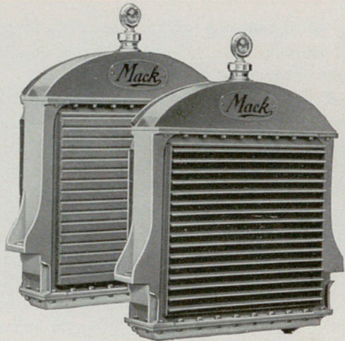
El enfriamiento eficaz se obtiene mediante un radiador con núcleo de aletas continuas y postigos de acero regidos a mano. El tanque superior de latón, el tanque inferior de aluminio y las chapas laterales del mismo metal montados con tacos de goma, suprimen todas las posibilidades de desarreglo
