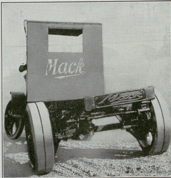
La flexibilidad del bastidor contribuye a la suavidad de la marcha, proporciona condiciones ideales para la transmisión por cadena y resguarda todos los órganos contra los esfuerzos y los choques
