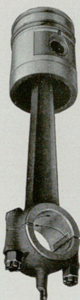
El perno del émbolo templado superficialmente, rectificado y amolado está fijado en la cabeza de biela y gira en bujes de bronce en el émbolo.
