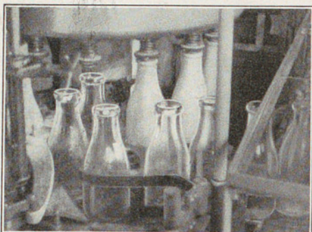
Embotellando leche automáticamente, de «Granjas lecheras de Wisconsin».
