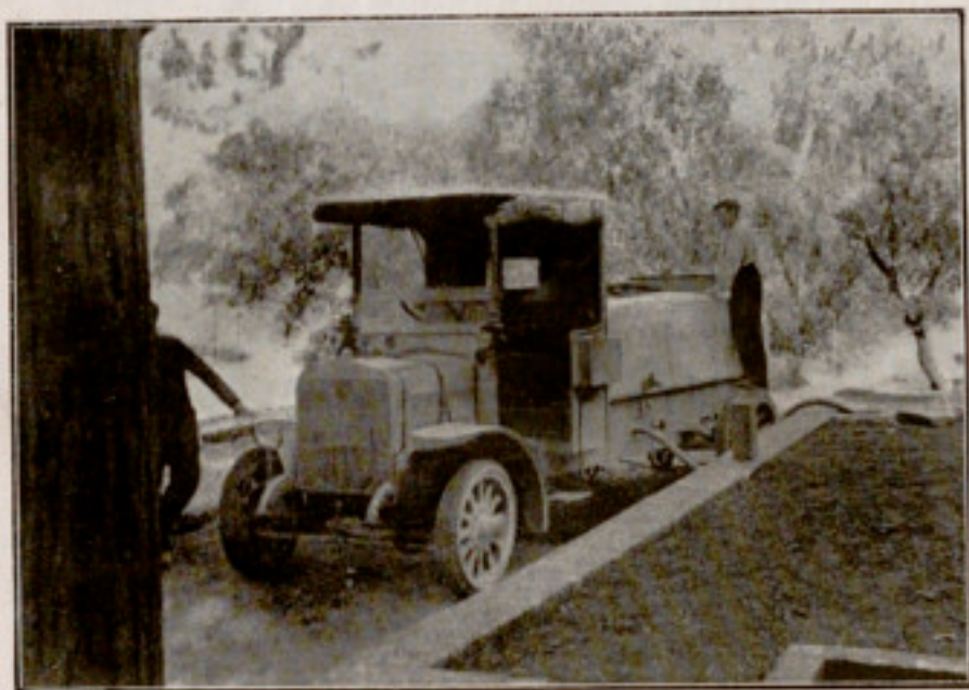
7. — Camió-regadora de la Mancomunitat prenent aigua en un dels dipòsits construïts expressament, aprofitant els sobrants o corrents públics, per al regatge de les carreteres amb clorur de calci.
