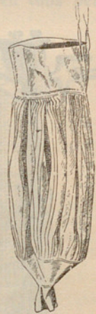
Fig. 41.—Mànega sens la xarxa protectora del filtre Magriña
