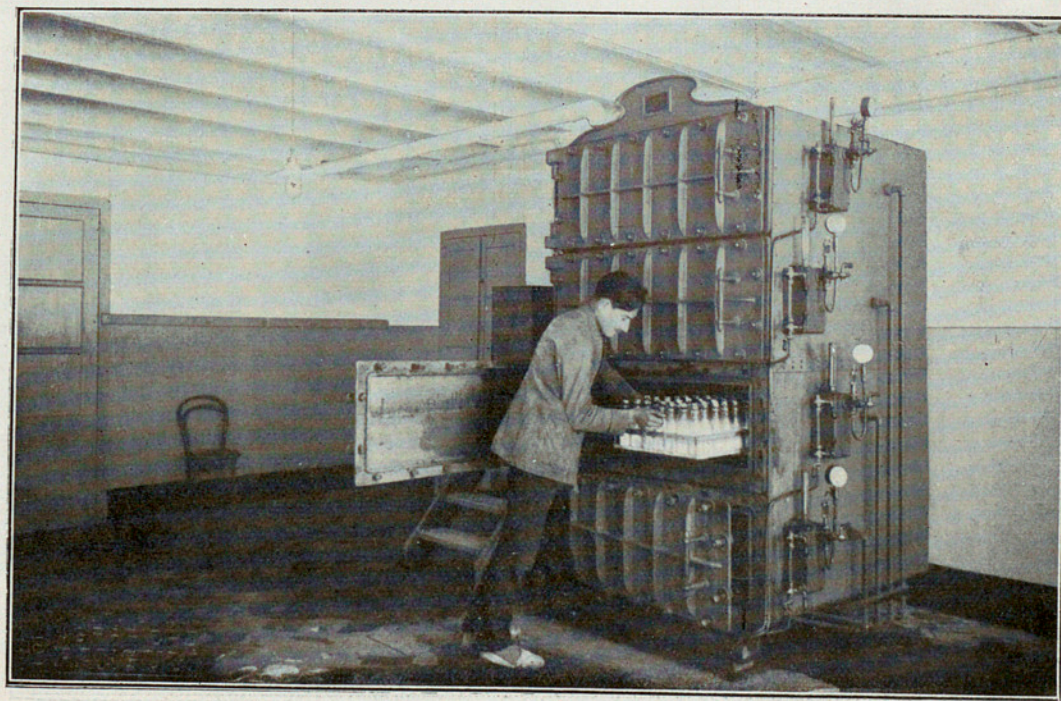
Autoclave para la pasteurización de biberones
